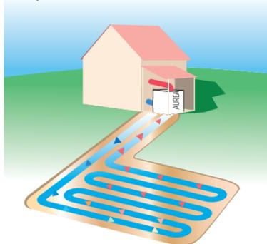
Su bomba de calor le proporcionará el agua caliente para su vivienda, gracias a la energía obtenida directamente del sistema. Con temperaturas de salida que pueden alcanzar los 60°C, Áurea contribuye en el ciclo de producción global de producción de agua caliente sanitaria, reduciendo los costes de explotación de la instalación.
